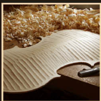
音板弧度 Plate Arching
