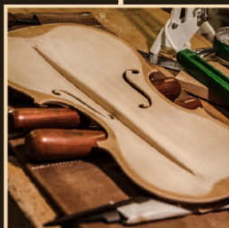
低音樑製作 Bassbar Making
